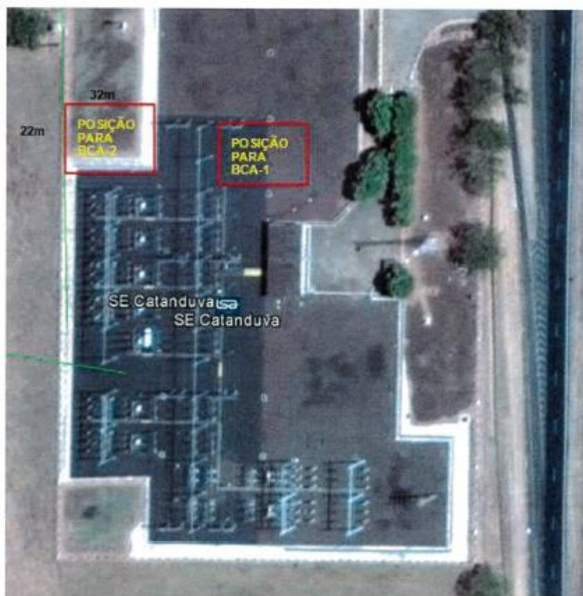
**Figura 1:** SE Catanduva – Áreas previstas para instalação dos novos bancos de capacitores
