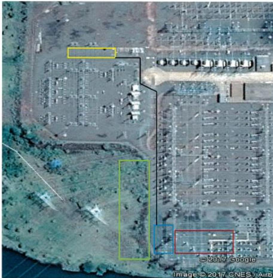
Figura 3 – Imagem do Google com a indicação dos locais de intervenção na SE AGV, para instalação do 2º banco de transformadores 440/138 kV 300MVA,
